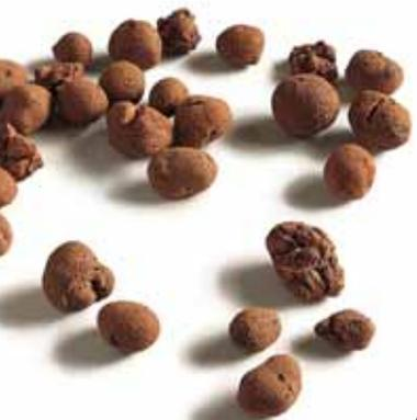
**Hohlraum-, Trocken- und Schallschutzschüttungen aus naturbelassenem Blähton**
